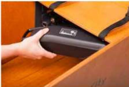
Der Akku-Ladekontakt befindet sich rechts. Der Anschluss ist ein Bajonettverschluss. => Bitte niemals einfach am Kabel ziehen! Zum Entfernen muss man den Stecker anfassen.
